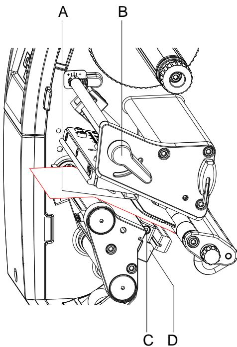
Die Etiketten-Lichtschranke kann zur Anpassung an das Etikettenmaterial quer zur Papierlaufrichtung verschoben werden. Der Sensor (A) der Etiketten-Lichtschranke ist beim Blick durch die Druckeinheit von vorne sichtbar und mit einer Kerbe im Lichtschrankenhalter markiert.
