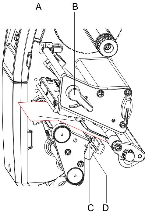
A címke anyagához való igazítás céljából a címke fénysorompója a papír menetirányához képest kereszten eltolható. A címke fénysorompójának érzékelője (A) a nyomtatóegységen keresztülpillantva előlről látható és egy, a fénysorompó tartójában lévő rovátkával van megjelölve.
