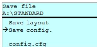
Sichert die komplette, aktuelle Druckerkonfiguration unter dem ausgewählten Namen.
