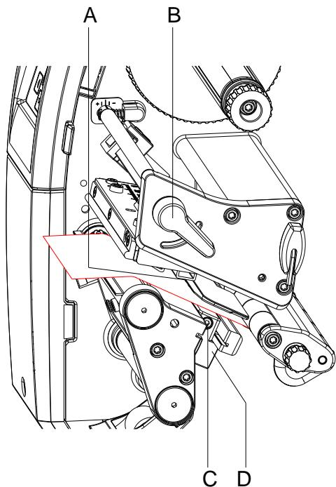
Для настройки на материал для этикеток можно двигать фотореле поперек направления движения бумаги. Датчик (A) фотореле виден при взгляде через модуль печати спереди и помечен маркировкой на вырезе фиксатора фотореле.
