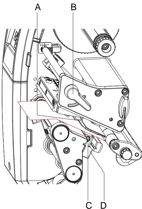
Bramkę świetlną można dopasować do materiału etykiet przesuwając ją w poprzek kierunku przesuwu papieru. Spoglądając od przodu przez jednostkę druku można zobaczyć detektor (A) bramki świetlnej oznaczony nacięciem w uchwycie bramki.
