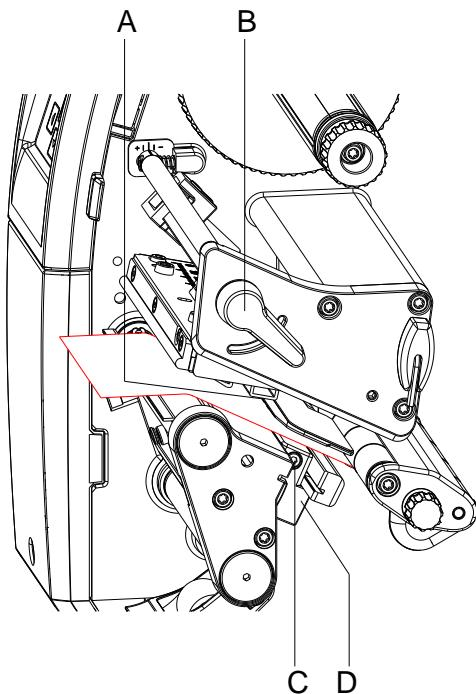
Etiketová světelná clona může být posunuta napříč ke směru běhu papíru tak, aby se přizpůsobila na etiketový materiál. Čidlo (A) etiketové světelné clony je při pohledu skrze tiskovou jednotku vidět ze předu a je označeno v držáku světelné clony pomocí zářezu.
