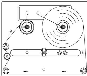
De afbeelding toont een links modulesysteem. Bij een rechts modulesysteem dient de nieuwe rol links en de huls rechts geplaatst te worden.
