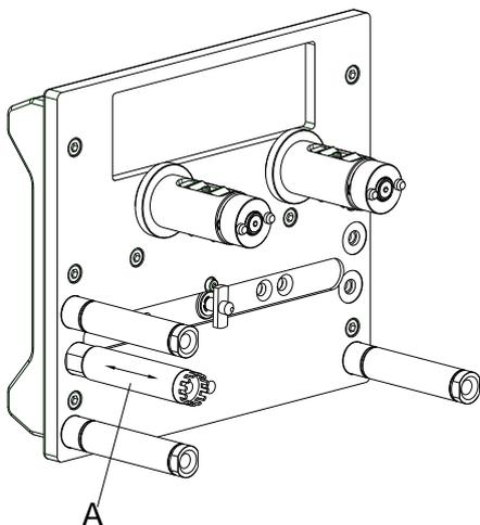
Kiristystelan likaantuminen aiheuttaa heikentyneen painojäljen ja saattaa heikentää materiaalin kuljetusta.
