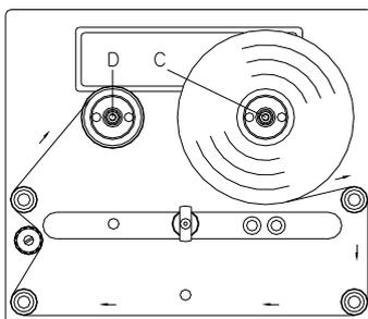
Kuvassa näkyy vasemmanpuoleinen painojärjestelmä. Oikeanpuoleisessa painojärjestelmässä uusi rulla asetetaan vasemmalle ja pahvihylsy oikealle.
