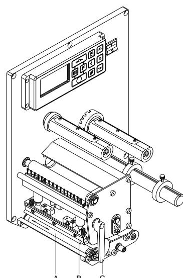
Painotelan likaantuminen johtaa huonompaan painojälkeen ja voi myös huonontaa etikettien kuljetusta.
