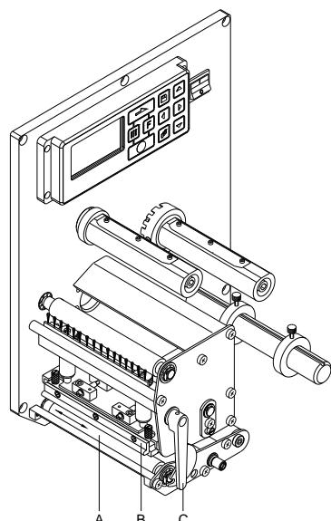
Eine Verschmutzung der Druckwalze führt zu einer schlechteren Druckqualität und kann außerdem zu Beeinträchtigungen des Materialtransports führen.
