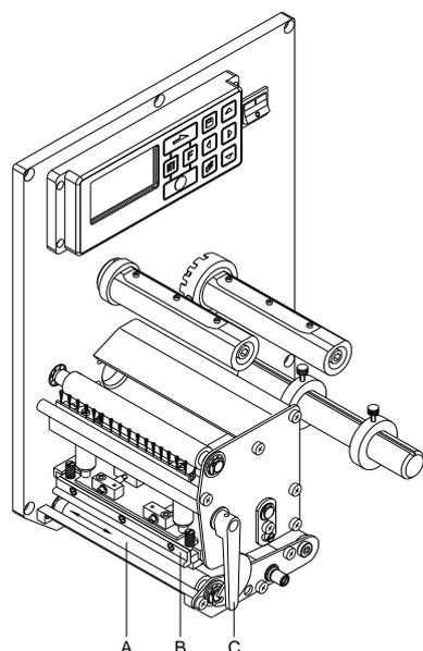
Znečištění tiskového válce vede ke zhoršení jakosti tisku a kromě toho může vést k omezení dopravy materiálu.
