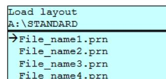
Elrendezés betöltése a meghatározott felhasználói könyvtáron belül. A funkció a kívánt elrendezés gyorsabb elérését teszi lehetővé, mivel csak az elrendezési fájlok (Layout-fájlok) jelennek meg. A könyvtárakat a rendszer elrejtí.
